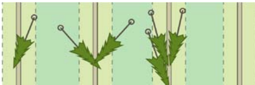
Abb. 15 Harvester-Fälltechnik sowie Beifällung, Aufarbeitung im „Königsbronner Verfahren“
