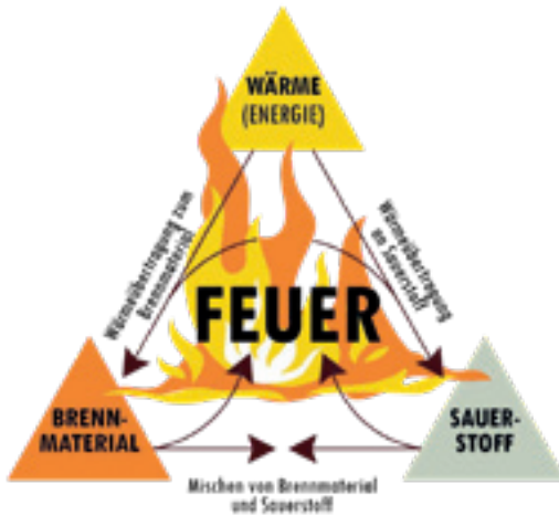
Abb. 1. Welche Elemente braucht es, damit ein Feuer entstehen kann und was können wir davon beeinflussen? Neben Wärme und Sauerstoff, ist Brennmaterial die einzig veränderbare Variable des Feuerdreiecks. Quelle: WKR Projekt
